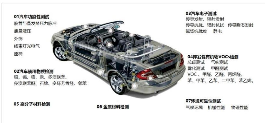
公司汽车领域检测主要包括汽车总成及零部件功能检测、汽车电子部件及 EMC 检测、高分子材料检测、金属材料检测、环境耐候及可靠性检测、整车及零部件材料 VOC 检测以及汽车材料禁限用物质检测等具体项目，具体如下：
